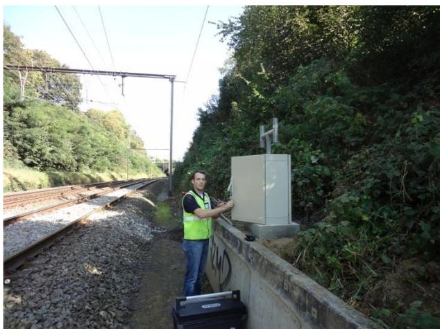
Le système APT-WIM (Weigh In Motion=Charge en Mouvement) est destiné à la détermination de l'effort d'impact dynamique appliqué à la voie par le véhicule.
